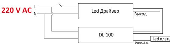
Структурная схема подключения
