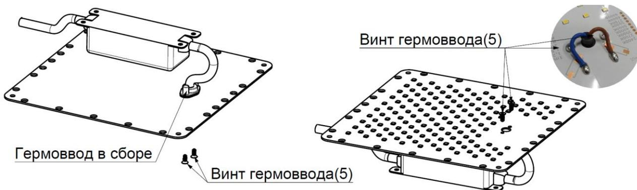
4. Припаять выводные концы источника питания к плате светодиодной (3) согласно полярности. При пайке применять флюсы низкотемпературные на основе канифоли типа ЛТИ-120 или СКФ. После пайки обязательно промыть место пайки спиртом.
