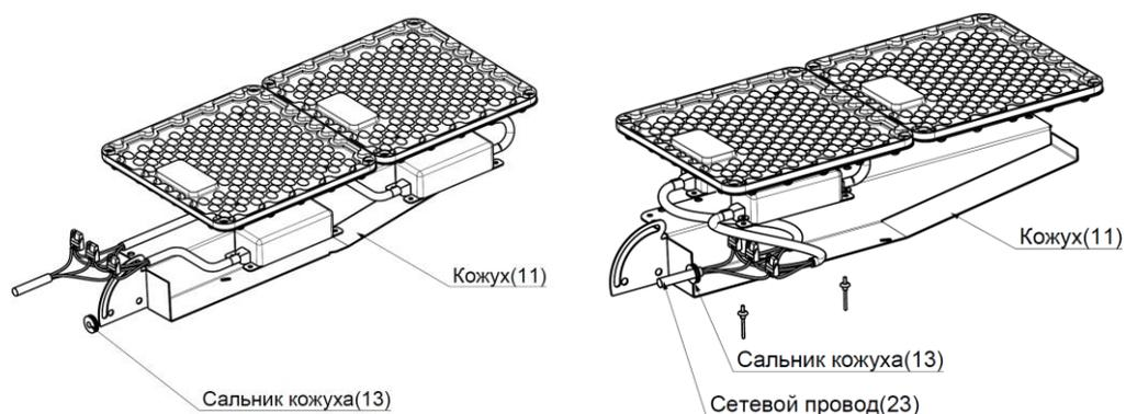
10. Закрепить заклепками 4x10 (10), предварительно продев через шайбу усиленную d4 (8), источник питания (9) на кожухе (11).
