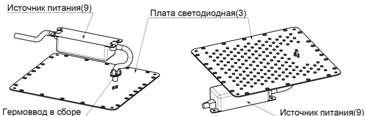
3. Установить гермоввод (7) на плату светодиодную зафиксировав винтами гермоввода (5).
