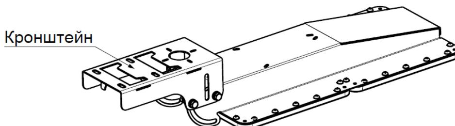
2. Установить хомут на кронштейн, закрепив используя Гайку хомута М6 , Шайбу хомута d6
